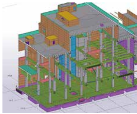
Kuva päätuotantorakennuksen elementtirungon suunnittelumallista näyttää hyvin jäykistysjärjestelmät rakennuksen 1- ja 3-kerroksisella osalla. Kuva suunnittelumallista: Sweco
