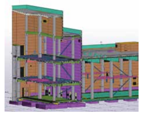
Kuva päätuotantorakennuksen suunnittelumallista näyttää 3-kerroksisen rakennuksen elementtirungon sekä sen jäykistysjärjestelmät eli kehäjäykistykseen ja vinosidejäykistykseen. Jäykistys on toteutettu Anstarin sidejärjestelmillä ja ristikko-liitososilla. Kuva suunnittelumallista: Sweco
