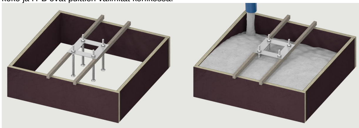
Kuva 31. Pulttien asennus kehikon avulla ja perustuksen valu
