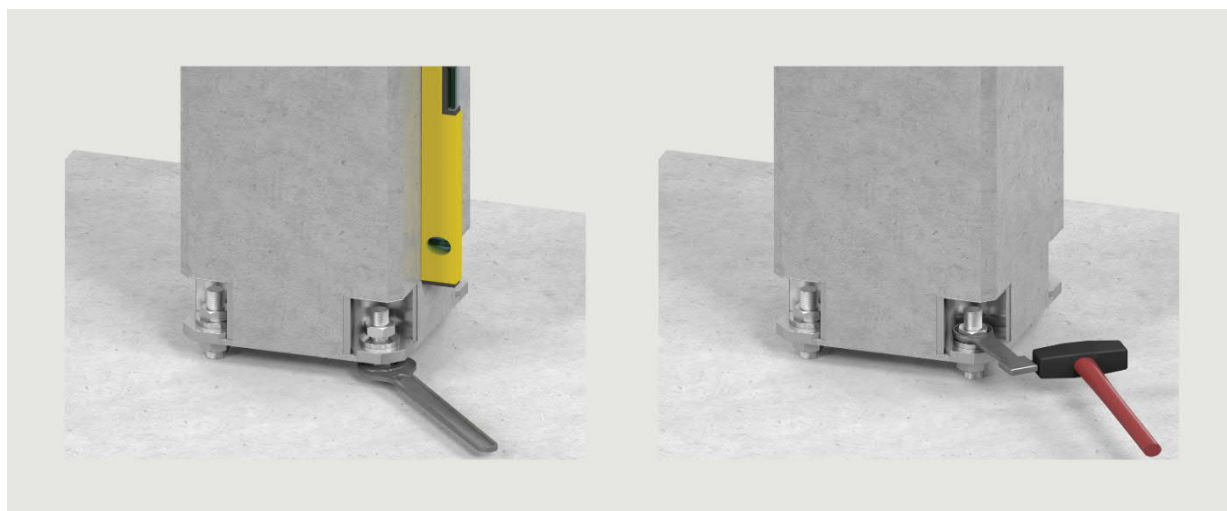
Kuva 29. Pilarin nosto ja liitoksen asennus
